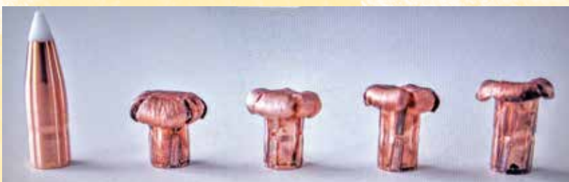
La munition TPM-C, du cuivre, un insère et pour une déformation régulière pour un transfert d'énergie maximisé à différentes distances.
